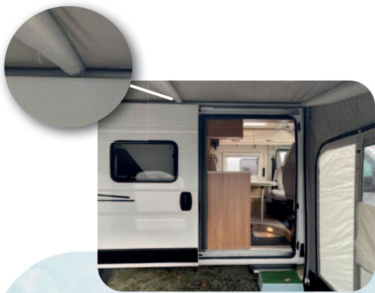
Durch die Verjüngung der Air Tubes haben wir eine Entwicklungslösung gefunden, die das problemlose Öffnen Schließen der Schiebetür ermöglicht.
